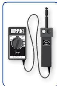
Комбинированные приборы, предназначенные для измерения яркости протяжённых самосвещающихся объектов накладным методом (экранов мониторов), освещённости в видимой области спектра (380 ÷ 760) нм, энергетической освещённости в области спектра (280 ÷ 400) нм — УФ-(A+B), температуры и относительной влажности воздуха внутри помещений.
