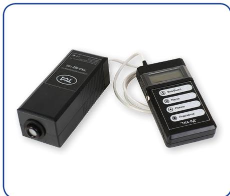
В зависимости от модификации прибор измеряет яркость (ТКА-ВД/01) или освещённость (ТКА-ВД/02) измеряемого источника оптического излучения.
