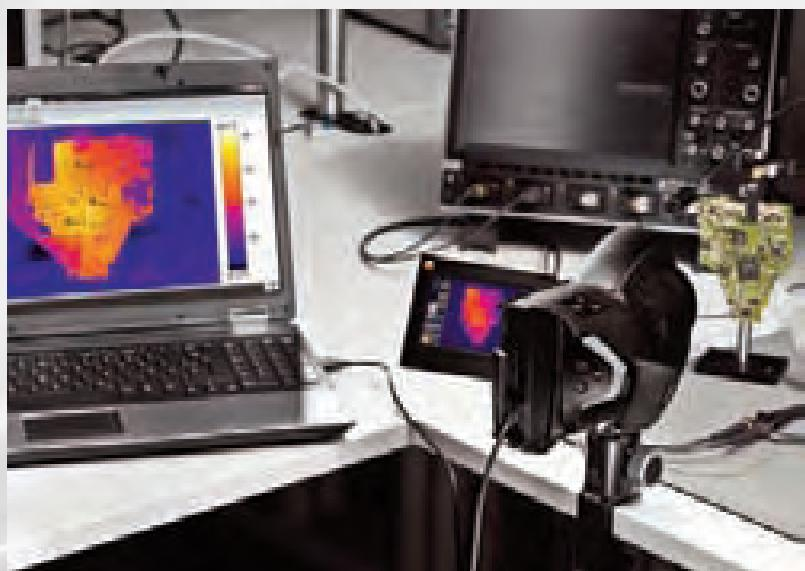
Любой фрагмент записи содержит данные температуры по каждому пикселью, что позволяет с точностью проанализировать все стадии процесса нагрева в течение определенного промежутка времени. Кроме того, функция регистрации данных обеспечивает возможность создания серии отдельных изображений в заданные временные интервалы или после определенных событий, например, превышения допустимых предельных значений.
