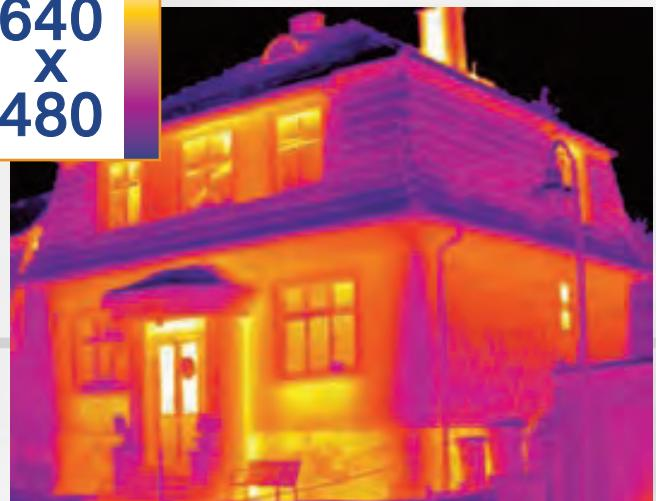
При регистрации самых незначительных перепадов температур особенно важным фактором является оптимальная температурная чувствительность (NETD). Тепловизоры Testo предлагают превосходную температурную чувствительность до < 30 мК, которая – в комбинации с высокой разрешающей способностью – позволяет визуализировать малейшие перепады температур независимо от размеров обследуемого объекта.
